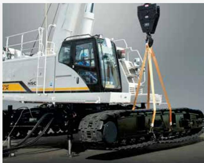
クローラ自力着脱装置(クレーン検査付) **OPTION**
