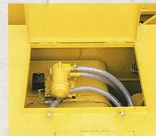
ビルジポンプ
