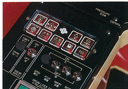
サービスモニター (写真のインジケータ類は撮影用に点灯させてあります。)
