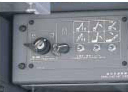
キー付き自動停止解除スイッチ 安全装置の不用意な解除を防止するために解除スイッチにキーを取り付けました。
