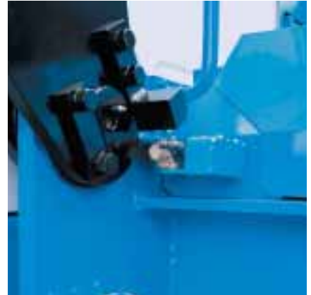
ブーム極限過巻防止装置 フック過巻防止装置、ブーム過巻防止装置のバックアップ機能として、ブーム極限過巻防止装置(ブーム角度82度で作動)を採用しました。ベル、ブザー警報のほか、音声メッセージで知らせます。さらにエンジンを停止させて動力を遮断、ブームのアオリによる倒壊事故を防ぐ機能を備えています。
