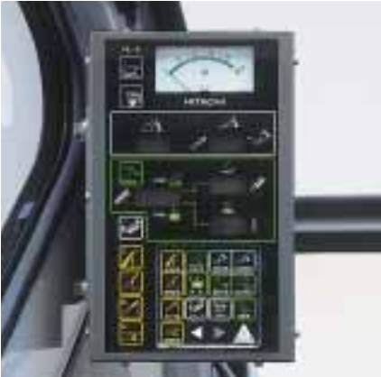
高機能モーメントリミッタ搭載 操作は文字表示付きキーボードで使いやすく、各種情報をオペレータに伝えます。
