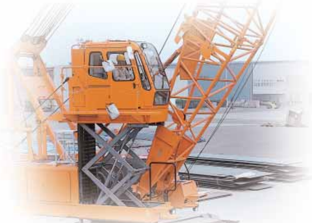
フリーフォールインターロック機構 ブレーキペダルを完全に掛けないと「フリー」に切り替わらないインターロック機構付き。
