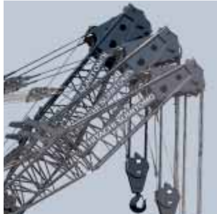
ブーム起伏緩停止機能 ブーム過巻・過負荷時の自動停止などによる、急停止のショックを小さくするブーム起伏緩停止機能を装備しました。
