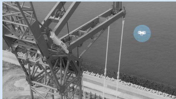
撮影画像を拡大（対象部材の塗装剥がれ）
