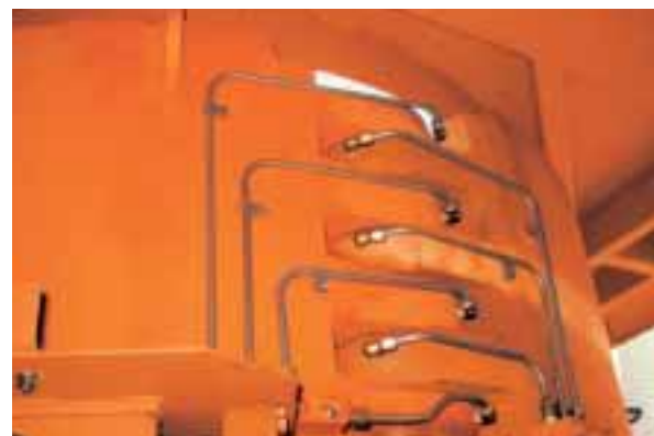
バンド装置ピンジ部への集中給脂
