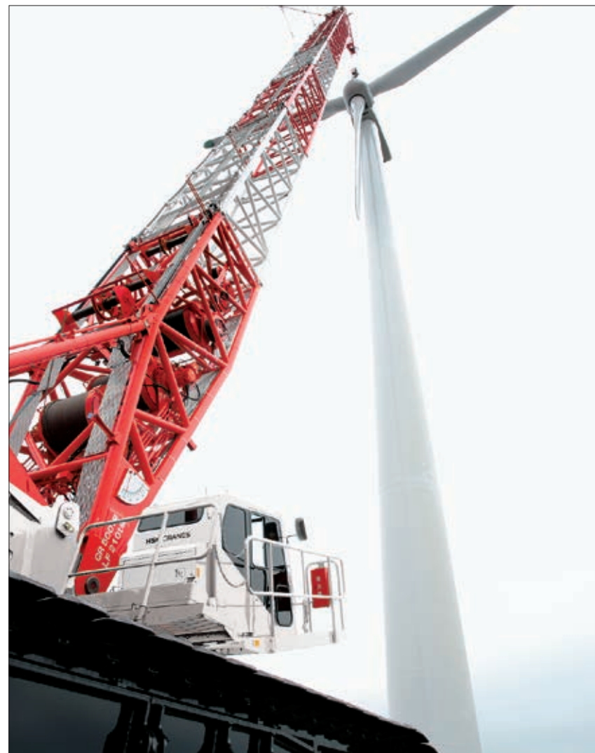
■ 7.62 m 補助ジブ (オプション) 風力発電機の据付け作業に最適
