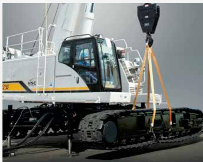
クローラ自力着脱装置(クレーン検査付) **OPTION**
