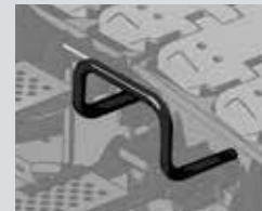
リアステップ部ハンドレール追加&幅拡大
