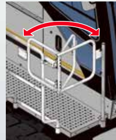
ハンドレールゲート部すべてを、 チェーンからパーティプ（自閉式）へ変更
