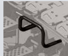
ロアステップ部ハンドレール追加&幅拡大
