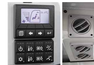
外気導入型エアコン
