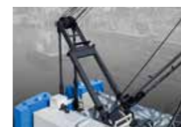
昇降シリンダ付折畳式ガントリ
