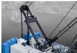
昇降シリンダ付折畳式ガントリー
