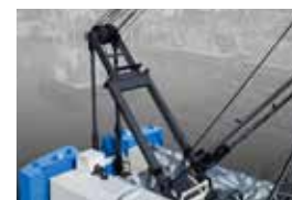
昇降シリンダ付折畳式ガントリー
