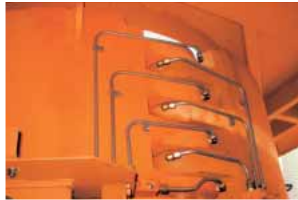
バンド装置ピンジ部への集中給脂
