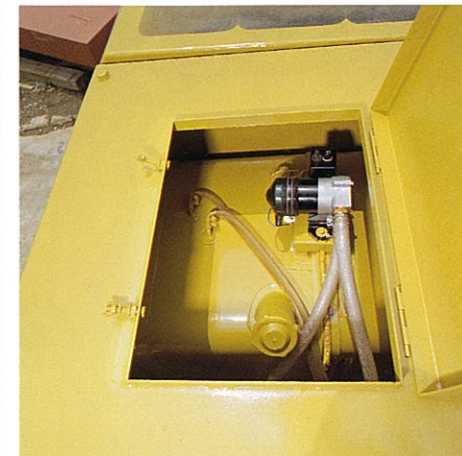
ビルジポンプ
