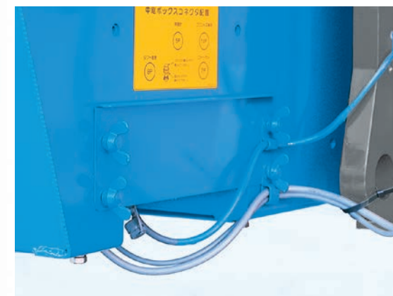
キャブ下にフロント電気配線コネクタを集中
