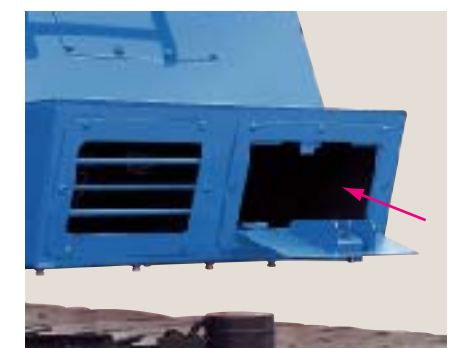
長尺物工具類の収納スペース
