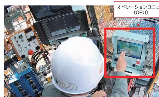
自動打設システムによってオペレーションユニットの画面をタッチするのみ
