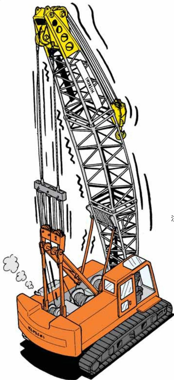
日立建機製KHシリーズ・クローラクレーンで、ブームを後方にあおる（倒壊）事故が発生しました。
