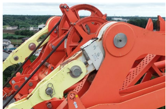
ピンの入り具合、ロードセル取付け状態
